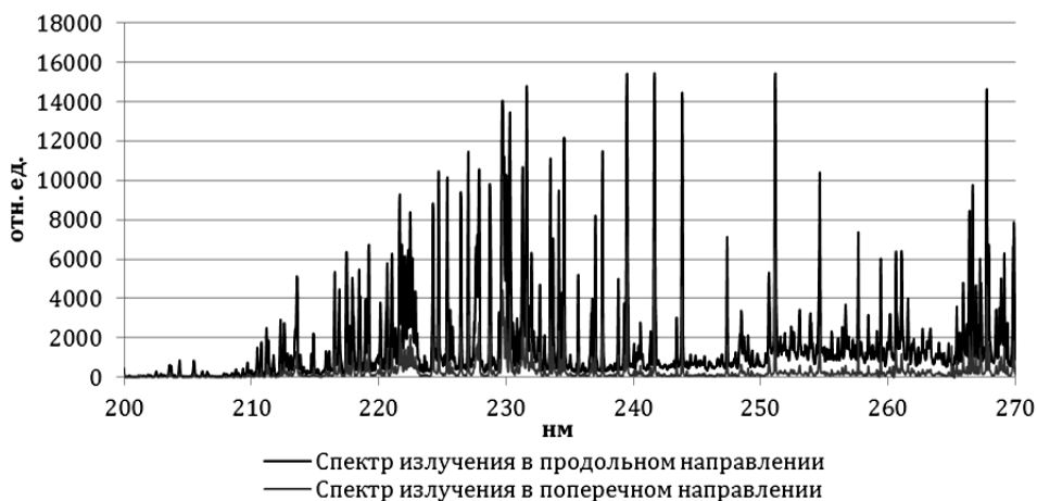
Рис. 3. Спектр излучения плазменного факела в ультрафиолетовой области; рабочее вещество – воздух + пары воды и бензина; 200 – 270 нм.
