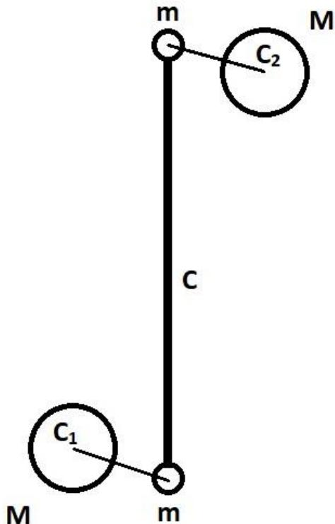
*Рис.5. Взаимное положение пар шаров к моменту начала движения малых шаров в направлении к большим шарам.*
