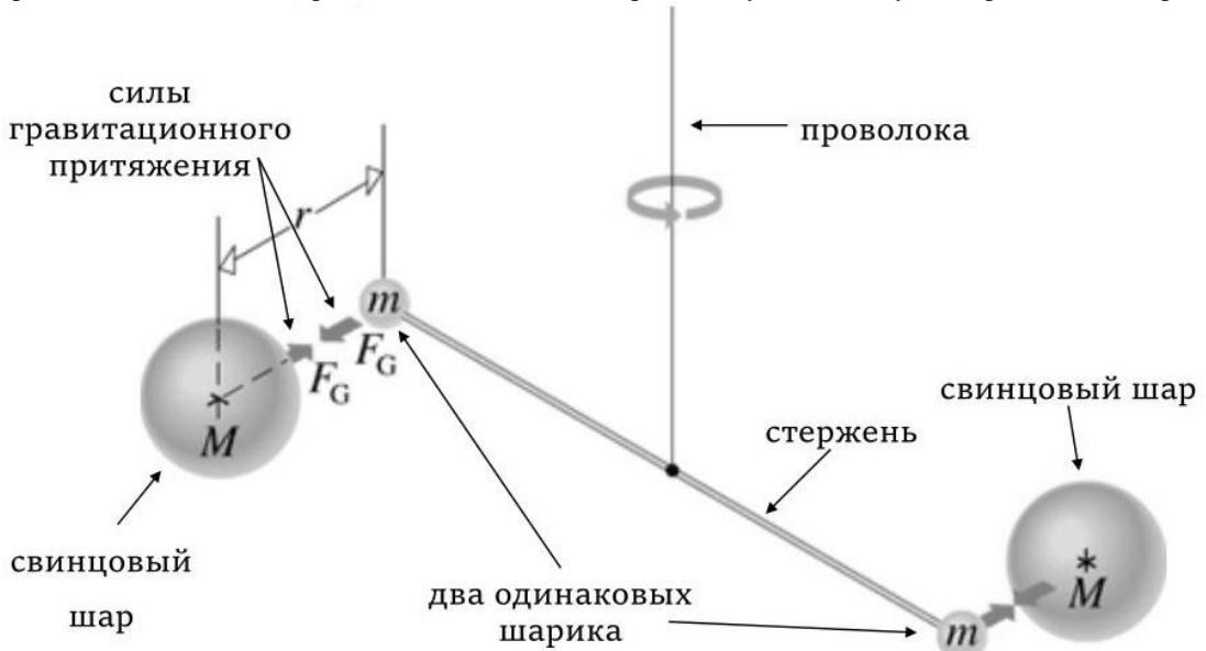
Рис.3. Схема эксперимента Г. Кавендиша.
