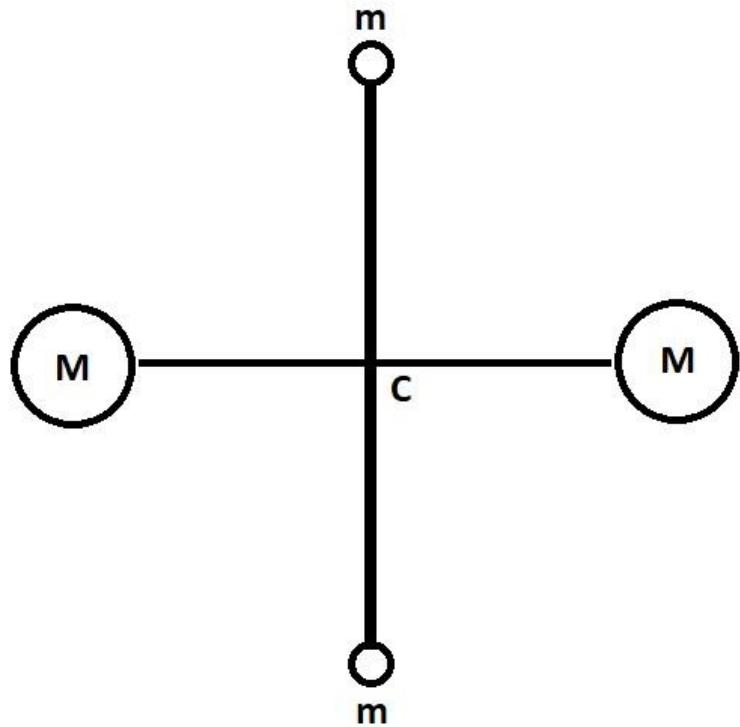
Рис.4. Состояние покоя кривильных весов.
