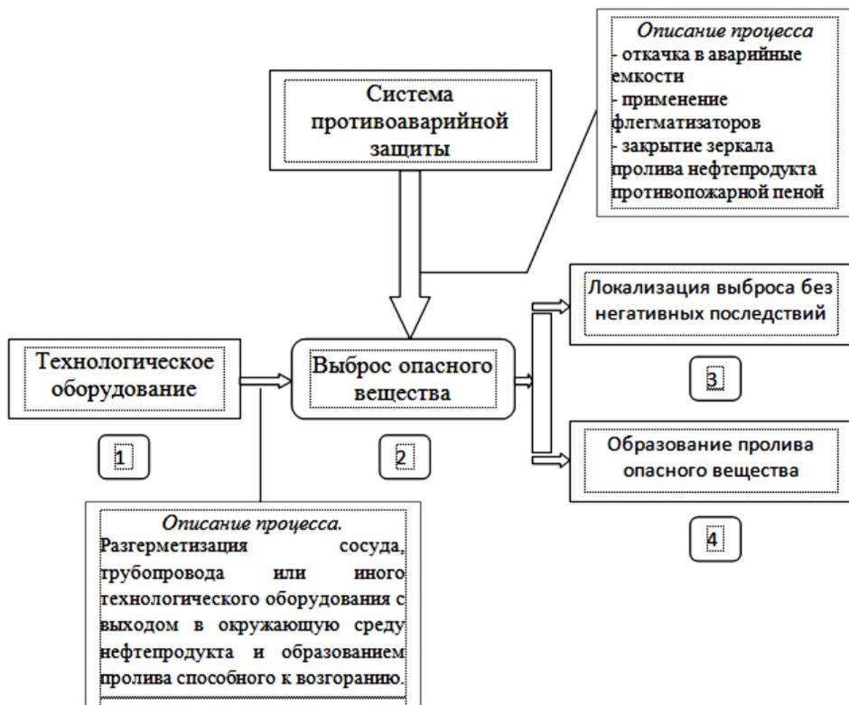
Рис. 1. Схема возникновения и развития аварии с локализацией выброса без образования источника ЧС (возгорание пролива, возгорание ТВС)
