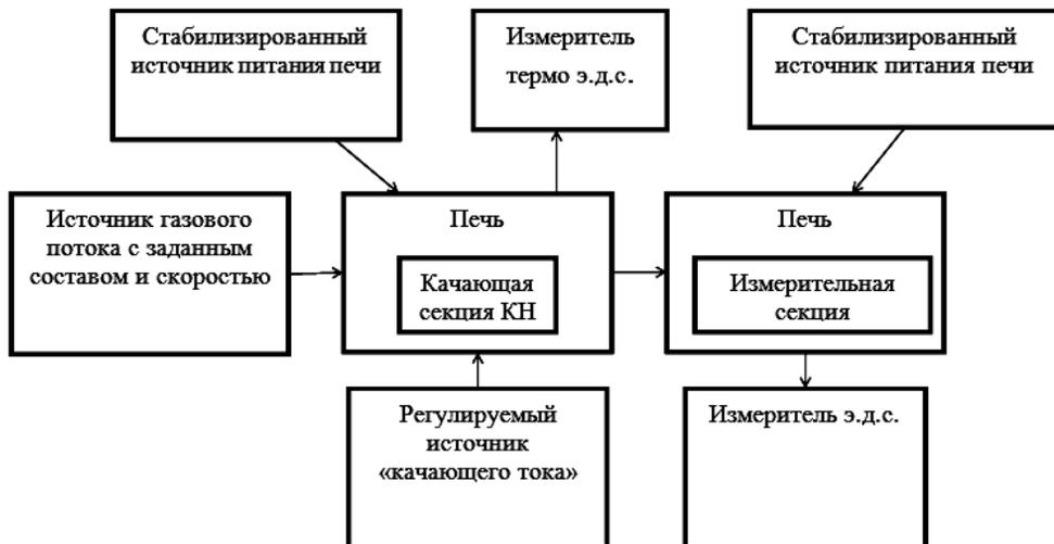
Рис. 2. Блок-схема кислородного насоса (КН)
