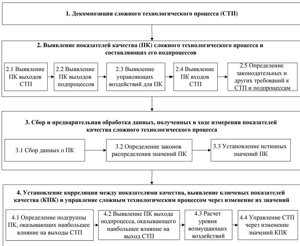
Рис. 1. Модель статистического управления сложными технологическими процессами
