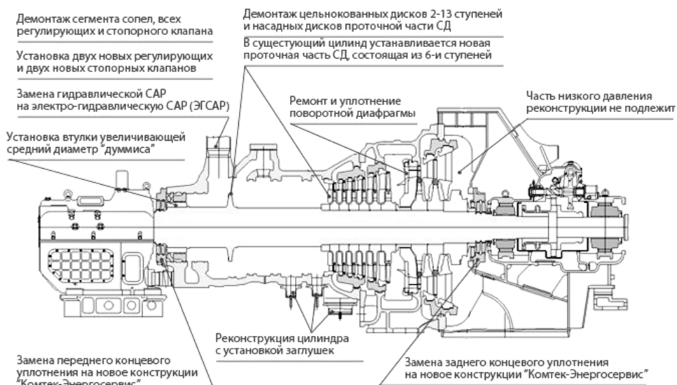
Рис. 1. Реконструкция турбогенератора типа ПТ-25-90-8.8
