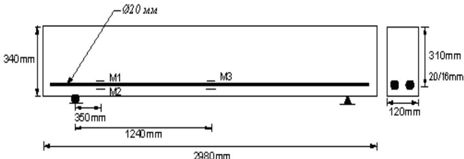
Рис. 1. Схема расположения внутренних датчиков на продольной арматуре
