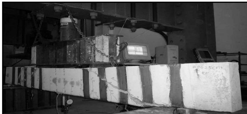
Рис. 2. Испытание экспериментальной прямоугольной балки при двухточечном изгибе
