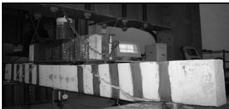
Рис. 2. Испытание экспериментальной прямоугольной балки при двухточечном изгибе
